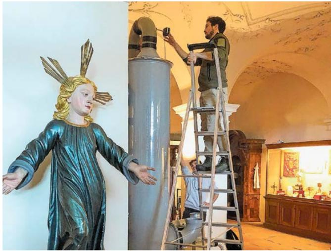
Mit einer Absorptionsanlage versuchten Studierende und Techniker der ZHAW, die Feuchtigkeit in der Sakristei zu reduzieren.
